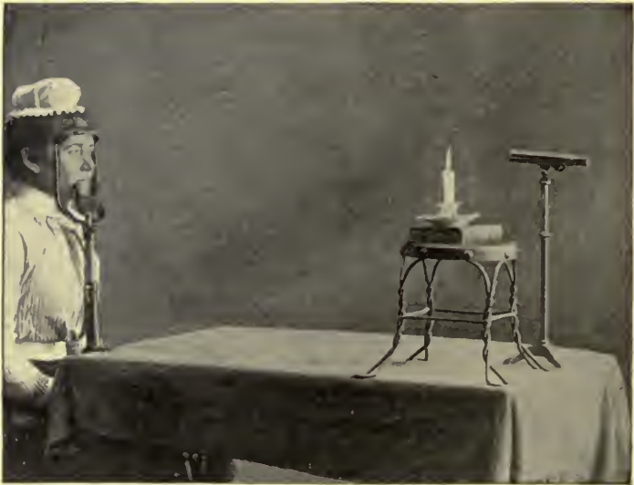
FIG. 153.—Telescope visuometer of the author.
